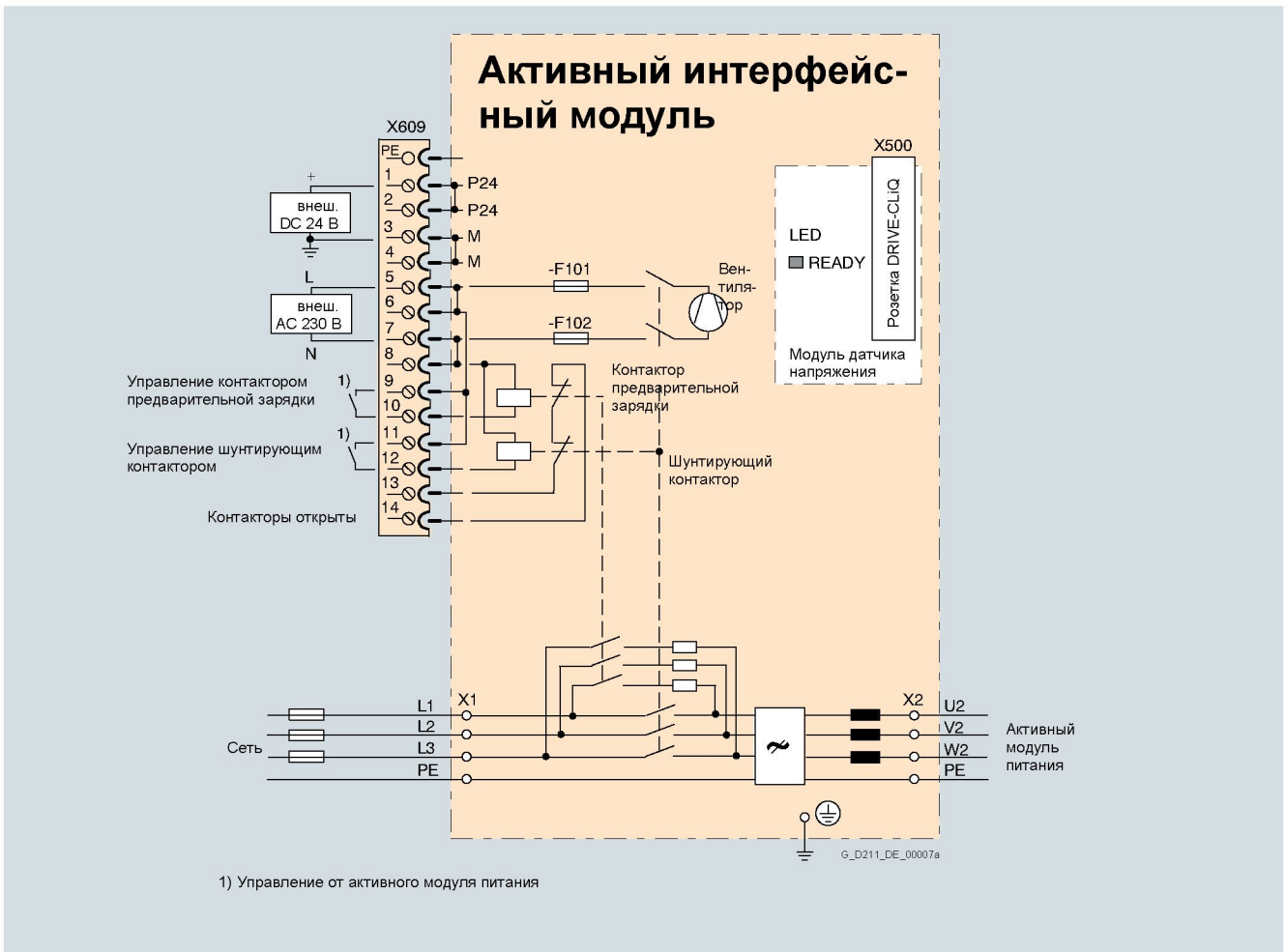
Пример подключения активного интерфейсного модуля с интегрированным шунтирующим контактором (конструктивные исполнения FI и G)
