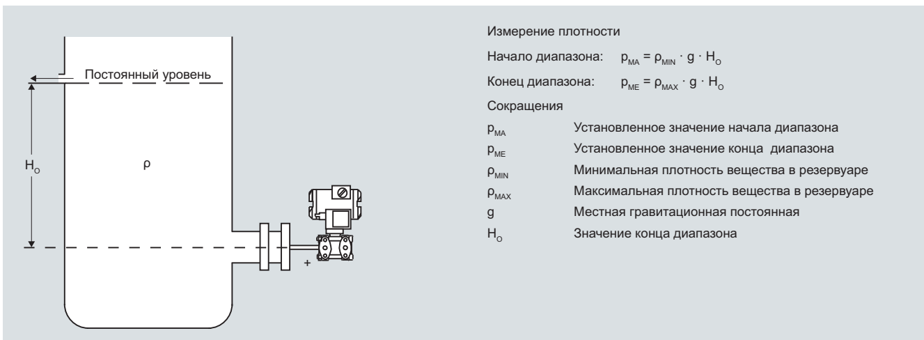
Измерительные схемы для закрытых резервуаров
