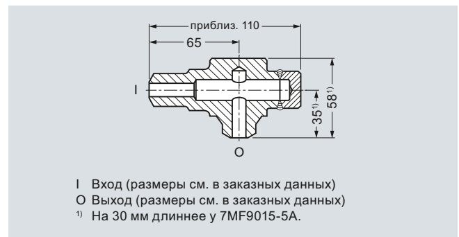
Уравновешивающий резервуар 7MF9015-5..., размеры в мм
