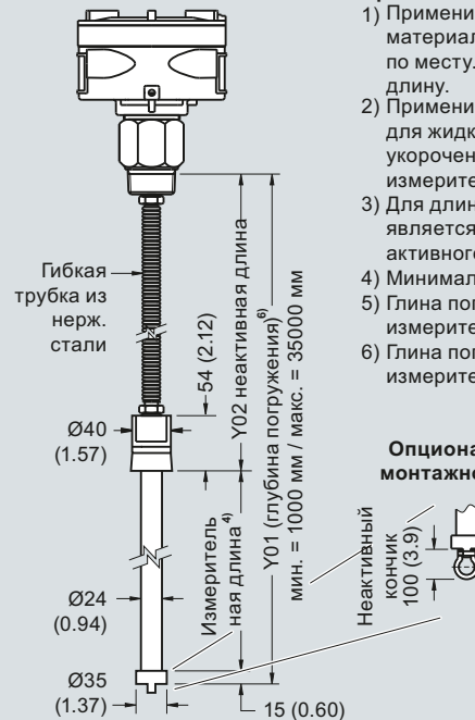
Удлиненная кабельная версия с антенным датчиком, Сварной фланец (7ML5523) 3)
