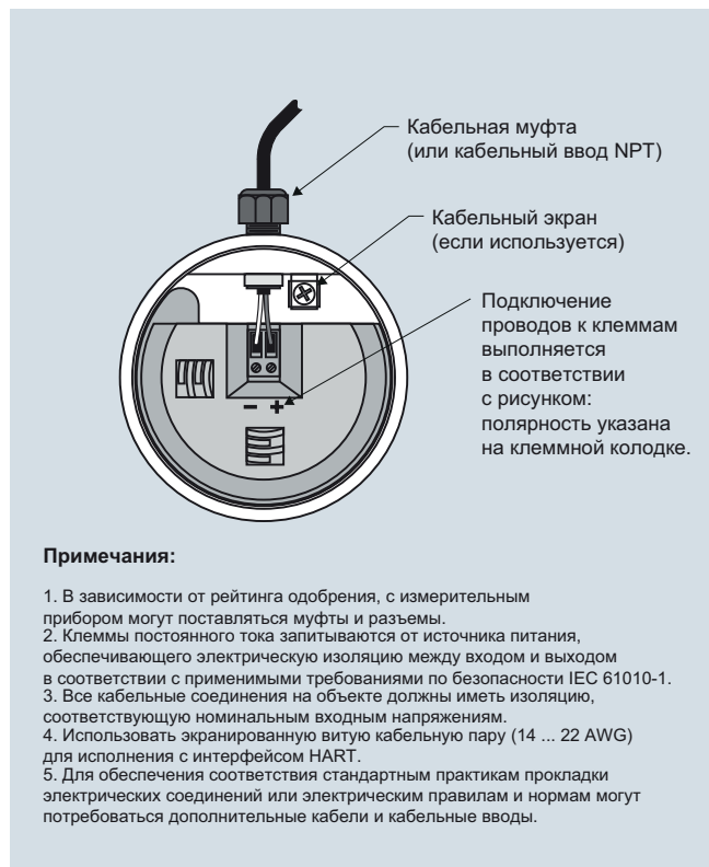
SITRANS LR560, схема соединений
